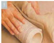
Gulung lempengan dengan cetakan dengan silinder.
